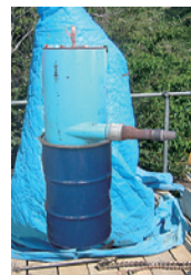
CMPカンプリート工法 (削孔スライム自動集塵搬送システム)
