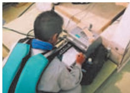
【比較：電波測位儀、アナログ式音響測深機を用いた深浅測量】
